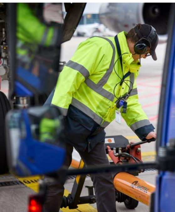
L'agent de rampe relie l'avion au remorqueur d'avion, également appelé « pousseur ». Celui-ci pousse ensuite l'avion vers le tarmac. L'agent de rampe informe ensuite le pilote et déconnecte le cockpit du circuit radio DECT et du pousseur.
