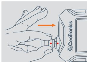
Inserte el conector en la toma presionándolo hasta que note que encaja.
