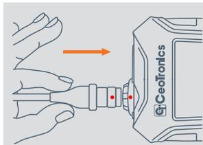
Coloque el conector en la toma. Asegúrese de que el punto rojo del conector y de la toma coincidan.
