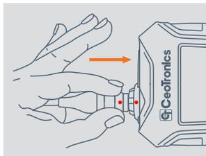
Inserte el conector en la toma presionándolo hasta que note que encaja.
