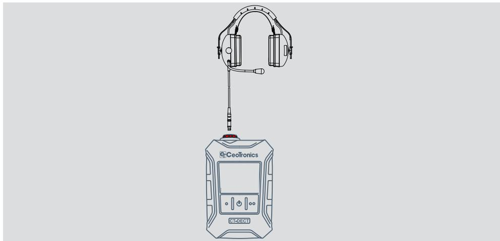
Un groupe DECT comprend toujours un appareil de base, également appelé Fixed Part (FP), et au moins un appareil standard, également appelé Portable Part (PP).
