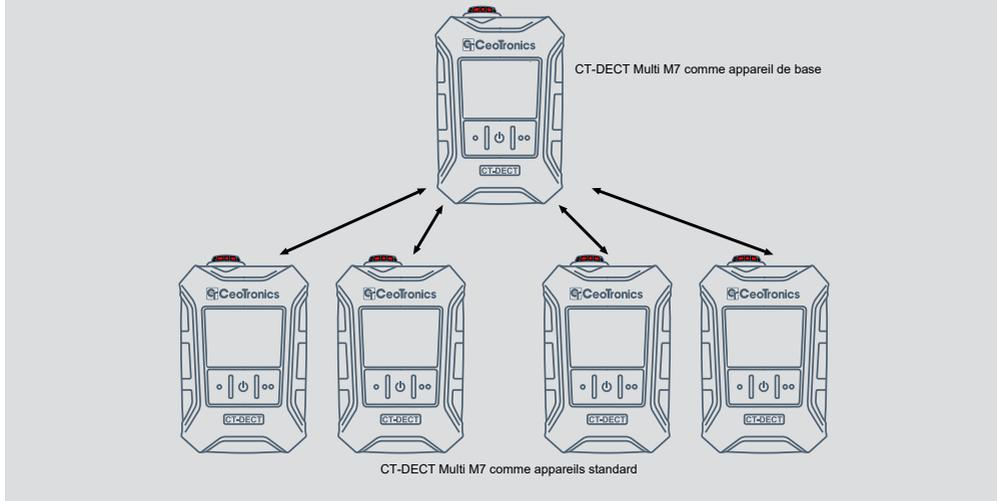
En fonction de l'équipement logiciel, le CT-DECT Multi M7 dispose de différents profils adaptés à différentes applications et rôles.
