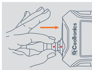
Inserte el conector en la toma presionándolo hasta que note que encaja.
