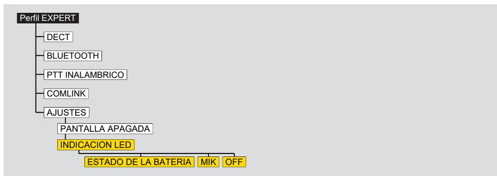
El ajuste por defecto es ESTADO DE LA BATERÍA.
