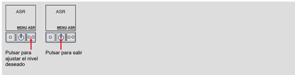
Se trata de un circuito en anillo: al nivel 4 le sigue el nivel 1. El ajuste por defecto es el nivel 3 («ASR natural»).
