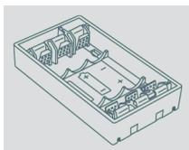
En los adaptadores AAA pueden utilizarse pilas recargables de NiMH o pilas alcalinas. Se recomienda el uso de pilas recargables de NiMH.
