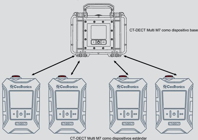
En función del software utilizado, CT-DECT Multi M7 dispone de varios perfiles adecuados para diferentes aplicaciones y funciones.
