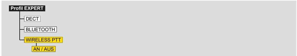
Wenn die WirelessPTT-Funktion aktiv ist, aber noch keine Verbindung zu einer WirelessPTT besteht, blinkt im Display das Zeichen WT.
