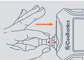
Drücken Sie den Stecker in die Buchse, bis der Stecker fühlbar einrastet.
