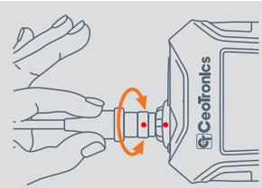
Drehen Sie den Stecker vorsichtig auf der Buchse bis er etwas in die Buchse hineingleitet.
