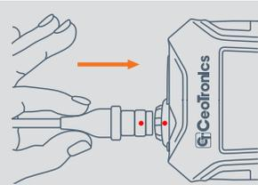
Setzen Sie den Stecker auf die Buchse auf. Achten Sie darauf, dass der rote Punkt auf Stecker und Buchse übereinstimmen.
