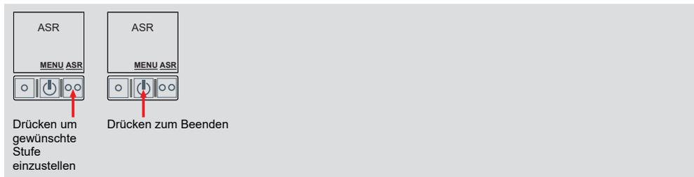
Es handelt sich um eine Ringschaltung: auf Stufe 4 folgt Stufe 1. Die Standardeinstellung ist Stufe 3 („ASR natürlich“).
