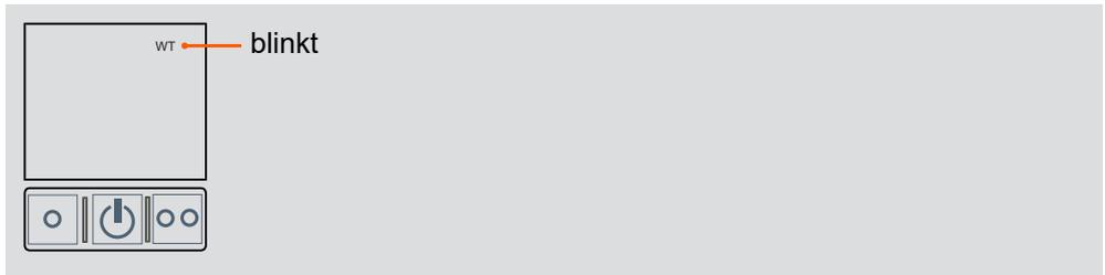
Die WirelessPTT-Funktion kann ausgeschaltet werden, um das CT-DECT Multi M7 von der CT-WirelessPTT MIL zu trennen ohne die Kopplung zu löschen.
