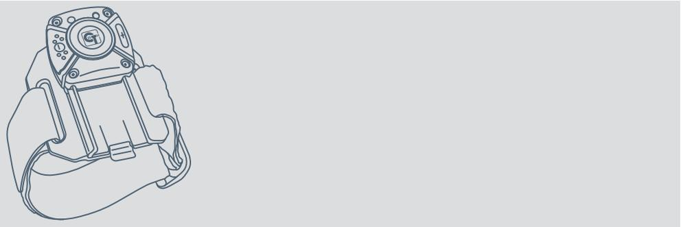
Zum Entfernen drücken Sie die Verriegelung (Pfeil) nach unten und schieben Sie die CT-WirelessPTT MIL aus der Halterung.
