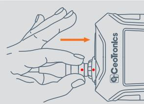
Drücken Sie den Stecker in die Buchse, bis der Stecker fühlbar einrastet.
