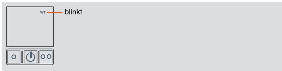
Die WirelessPTT-Funktion kann ausgeschaltet werden, um das CT-DECT Multi M7 von der CT-WirelessPTT MIL zu trennen ohne die Kopplung zu löschen.
