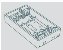
In den AAA-Adaptern können NiMH-Akkus oder Alkalibatterien verwendet werden. Die Verwendung von NiMH-Akkus wird empfohlen.
