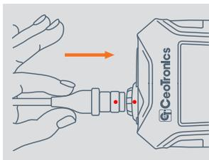
Setzen Sie den Stecker auf die Buchse auf. Achten Sie darauf, dass der rote Punkt auf Stecker und Buchse übereinstimmen.
