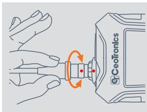
Drehen Sie den Stecker vorsichtig auf der Buchse bis er etwas in die Buchse hineingleitet.
